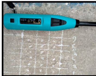
Figura 4. Esclerómetro Proceq Silver Schmidt.
