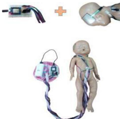
Nota. Se observa la composición de prototipo, se tiene el controlador, adecuación de los sensores en los puntos estratégicos en el neonato y conexión de los cables.
