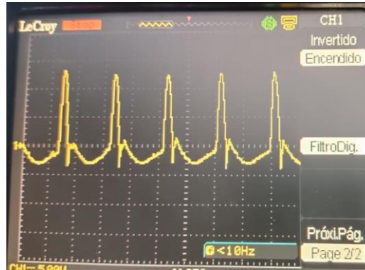
Figura 17. Lectura de una presión en función de la conversión voltaica promedio en 140 psi a 300 msnm
