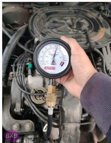
Figura 16: Lectura en el compresómetro de 132 psi a 300 msnm
