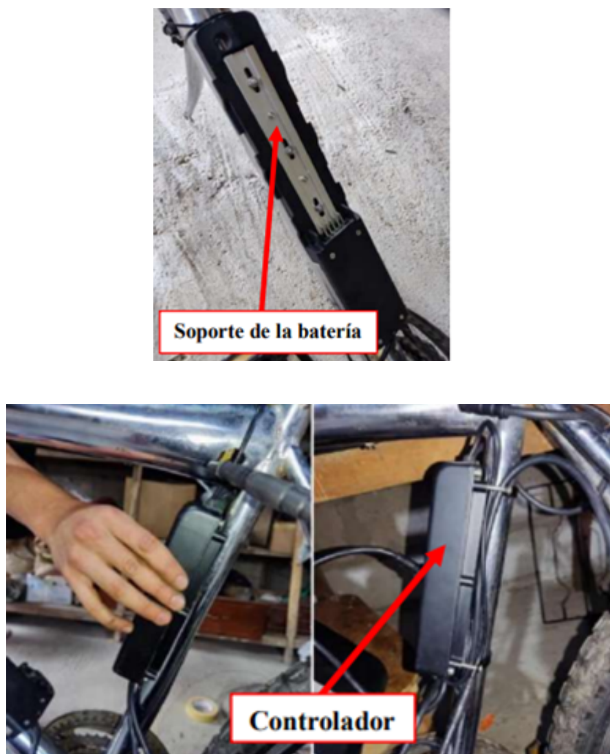
Figura 4. Colocación de soporte de batería y controlador
