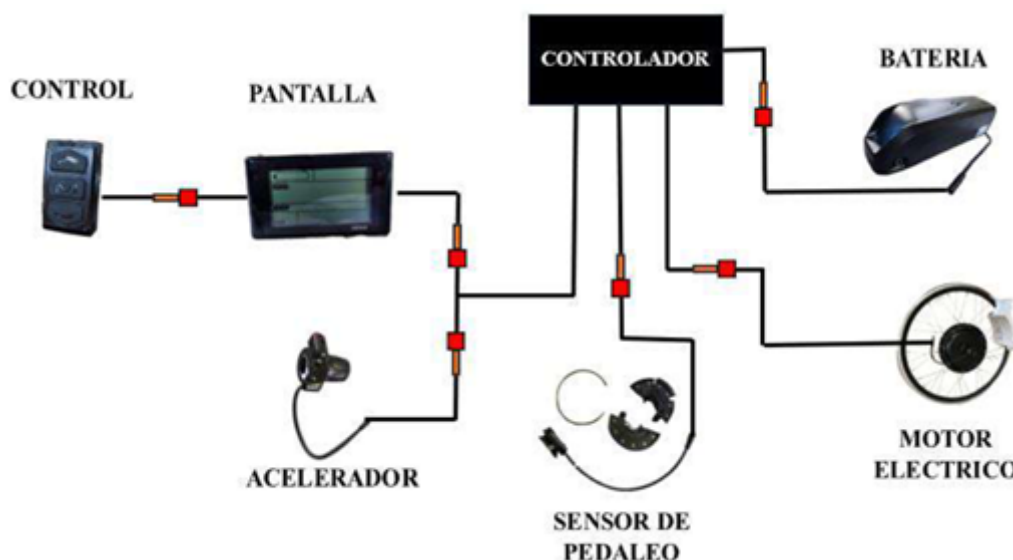
Figura 2. Diagrama de conexión de kit de conversión
