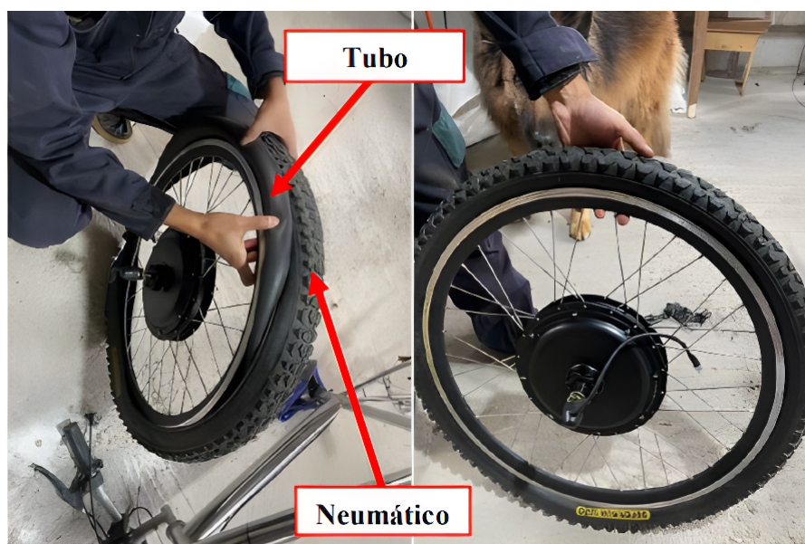
Figura 3. Enllantado del aro del motor eléctrico
