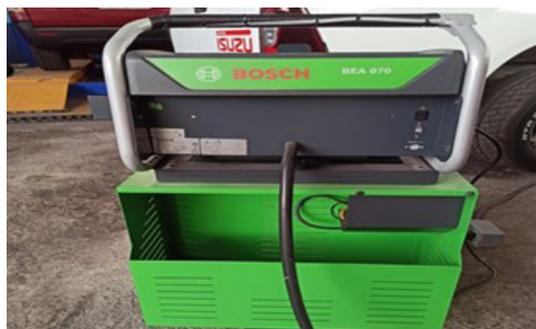
El opacímetro móvil es utilizado para realizar las pruebas de humo a los automotores diesel diseñada para obtener las medidas de opacidad en vehículos a gasóleo de manera eficiente, comúnmente se los puede encontrar en talleres de inspección técnica de vehículos. Su funcionamiento es mediante un software instalado en una portátil. La transferencia de datos lo hace por conexión bluetooth.
