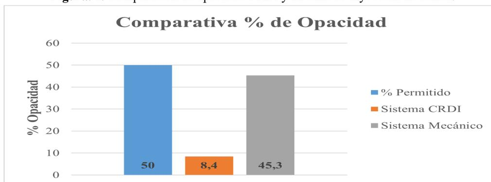
En el análisis comparativo subsiguiente se examinarán con mayor profundidad los índices de opacidad emitidos por el conducto de escape de cada motor, contrastándolos con el umbral de porcentaje permitido según las especificaciones técnicas establecidas por la normativa ecuatoriana INEN.
