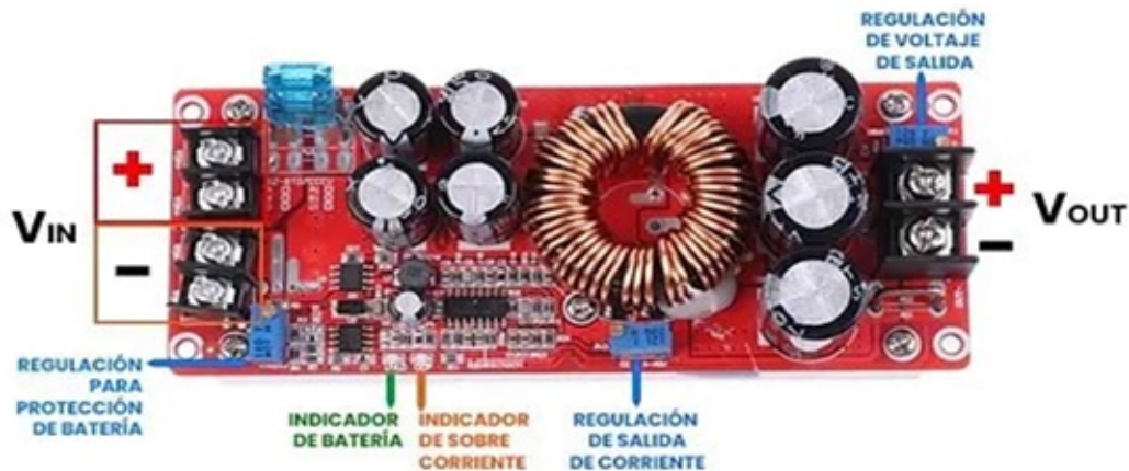
Figura 4. Convertidor de voltaje 12Vdc-60Vdc
